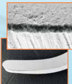
Břit kyrety Sharp Diamond Břit a jeho zvětšení po použití.
